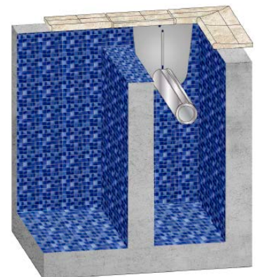
BERMUDA > Motor en el eje de enrollamiento; > Soportes fijados al muro por debajo de la corona.
