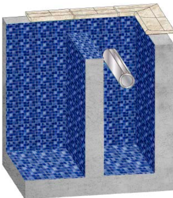
IBIZA > Motor en el eje / tubo de enrollamiento; > Soportes fijados a las paredes laterales.
